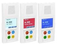
Bis zu 6 verschiedene, frei programmierbare Tasten können im Touch-Display angezeigt werden. So ist es möglich, mit nur einem Tastendruck die gewünschte Funktion zu wählen.
