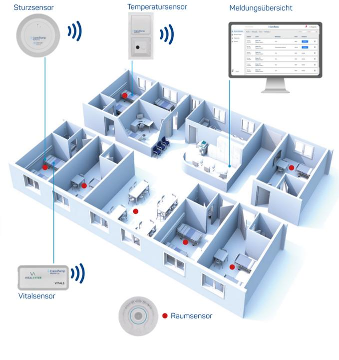
Eine Vielzahl unterschiedlicher Sensoren erfassen Pflegedaten automatisch und übertragen sie direkt in die bestehende Pflegesoftware. Zusätzlich werden die automatisch generierten Alarme direkt in die Rufanlage übertragen. So ist das Pflegepersonal zu jeder Zeit informiert. Arbeitsroutinen können effizienter gestaltet werden und die Pflegequalität wird durch kürzere Reaktionszeiten erhöht.
