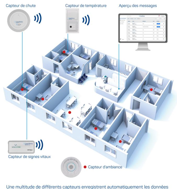
Une multitude de différents capteurs enregistrent automatiquement les données relatives aux soins et les transmettent directement au logiciel existant. De plus, les alarmes générées sont transmises en parallèle sur l'appel infirmier. Grâce à ces capteurs, la moindre complication peut permettre un déclenchement d'alarme instantanément, ce qui permet d'améliorer la qualité de prise en charge et de gestion des urgences.
